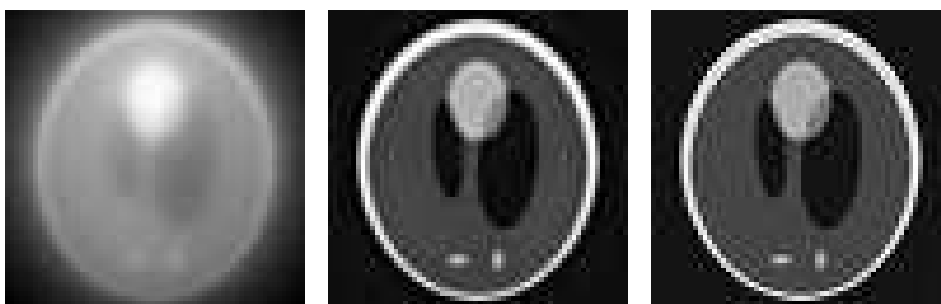
Abbildung 12. Rekonstruktion des Phantoms nach 1, 8 und 30 Iterationen des cgls-Verfahrens ( n = 64 , n_\varphi = 290 , n_P = 336 ).
