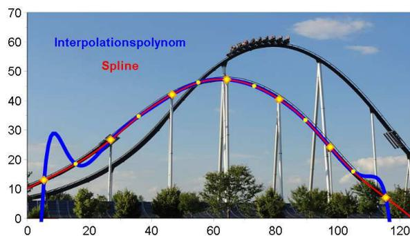
Abb. 3: Interpolationspolynom und Spline für 13 Stützpunkte.
